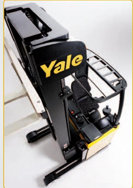
Sämtliche Modelle der neuen MR-Schubmaststaplerserie haben ein dreiteiliges Design. Die wichtigsten Unterscheidungsmerkmale zwischen den Modellen sind der Radstand und die Staplerbreite.
