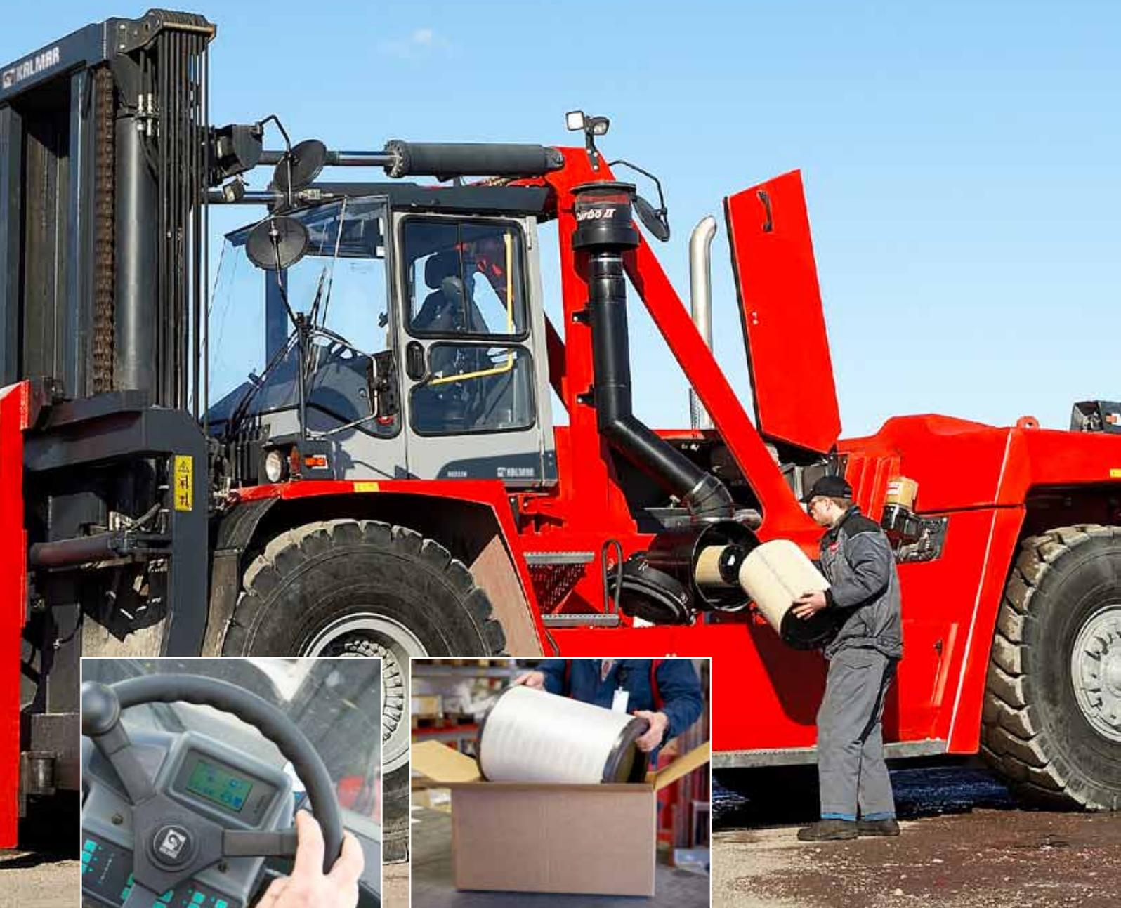
Warnungen und Fehlercodes werden dem Fahrer am Informationsdisplay angezeigt, um kostspielige Schäden zu vermeiden und um den Umfang ungeplanter Wartungen auf ein Minimum zu reduzieren.
